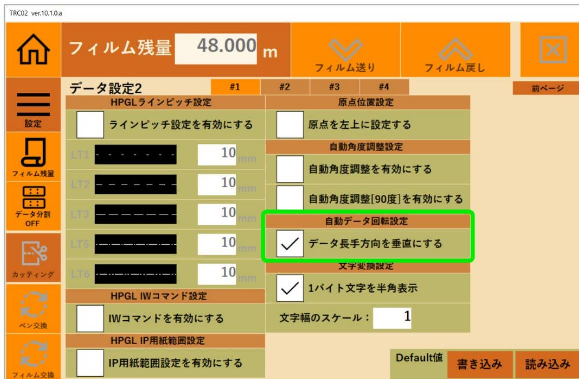
出力データの高さが幅より大きいデータで、その幅が900mmより短い場合、この機能を有効にすると、出力データを半時計回りに90度回転して出力します。その為、フィルム使用量を削減する事が出来ます。
