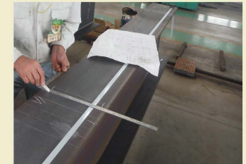
シナイ定規に描かれた記号に従いサシガネで鉄骨に書き込みます。
